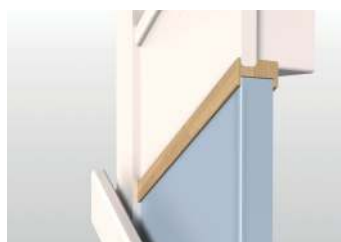
lisse sous limon pour cloison
