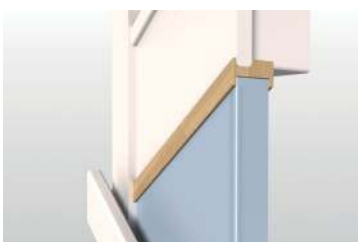
lisse sous limon pour cloison
